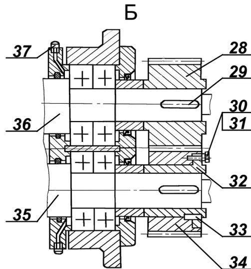
Рисунок Г.1 - Ремонтный комплект для насосов типа А5 2ВВ
