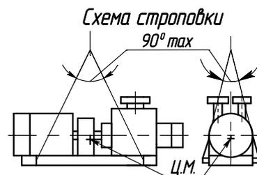
Рисунок Б1 - Габаритный чертеж агрегатов электронасосных на базе насосов типа А5 2ВВ50/25, А5 2ВВ 80/25, А5 2ВВ63/25
