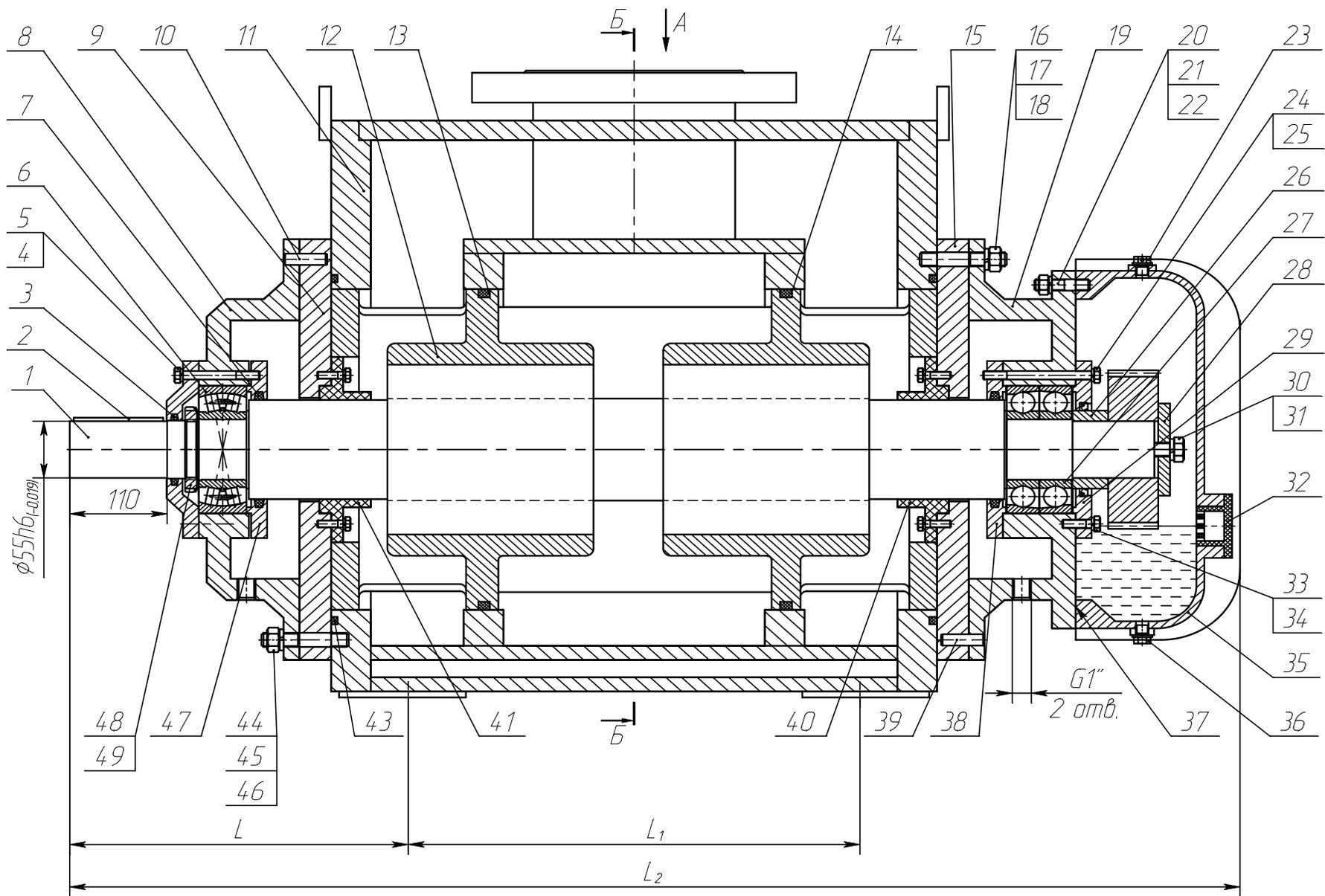
Рисунок 1 – Устройство насоса
